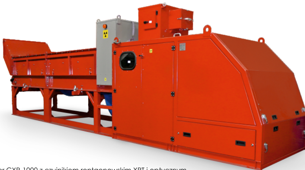
Sorter CXR-1000 z czujnikiem rentgenowskim XRT i optycznym
